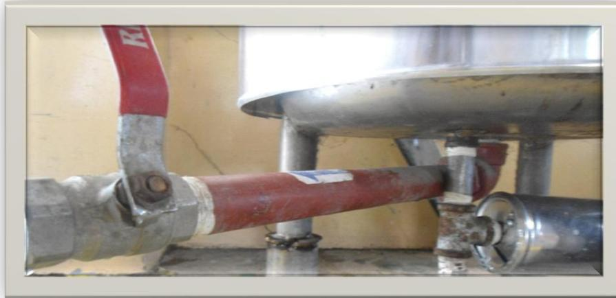
La línea de salida de producto se encuentra en la parte inferior del reactor, para la evacuación del producto terminado de la reacción, el mismo que cuenta con una válvula de cierre rápido.
