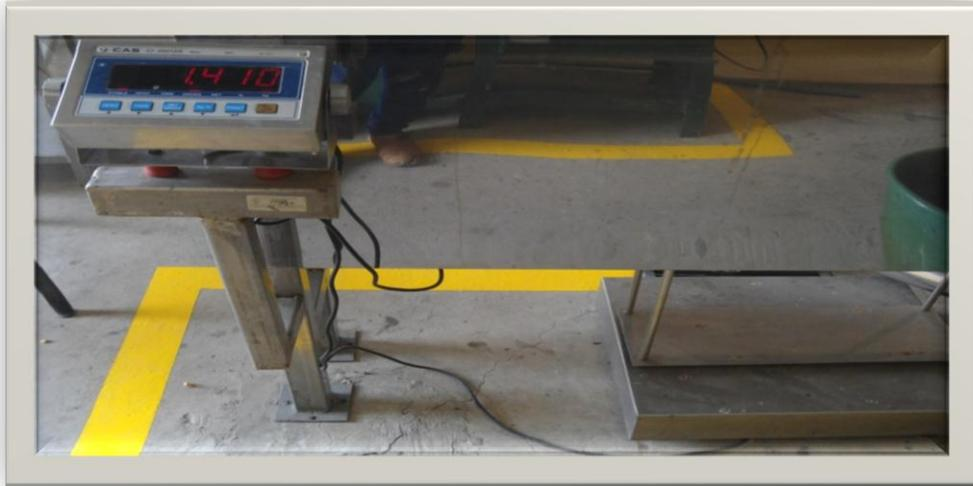
La balanza se encuentra en la parte inferior del secador de túnel y está conectada a las canastillas donde se coloca el producto.
