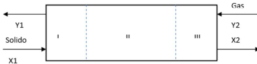
Representación esquemática de un secador de túnel
