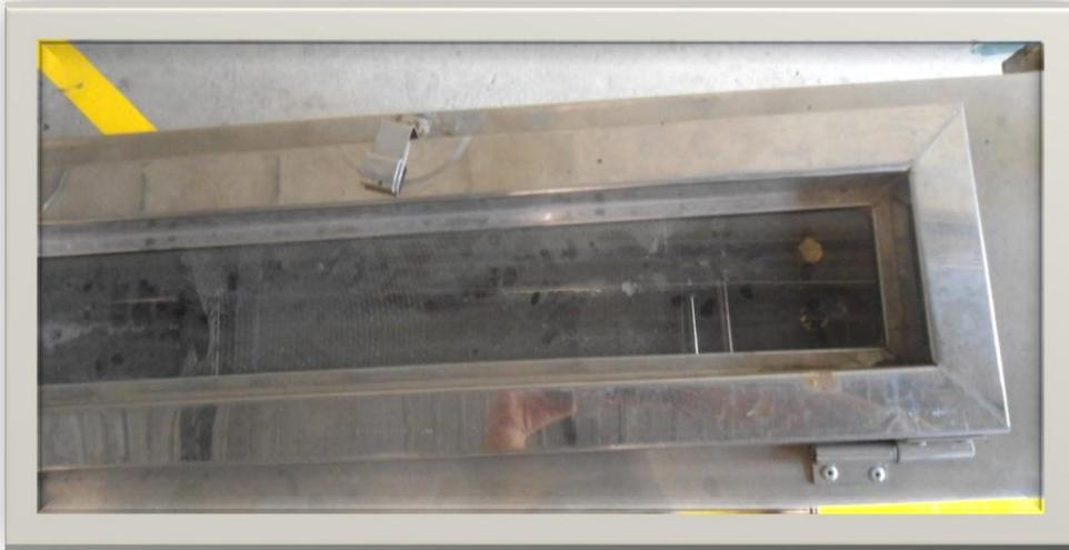
La cámara de secado es el lugar donde se realiza el desecado del producto con el que se esté trabajando haciendo circular por la misma una corriente de aire caliente proveniente de la cámara de aire.
