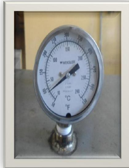
Los sensores de presión y temperatura se encuentran distribuidos a lo largo del equipo, el sensor de presión se encuentra en la unión de las líneas de alimentación de vapor, este equipo puede medir hasta 7 bares de presión, aunque la presión máxima de trabajo del secador es de 3.5 bares.
