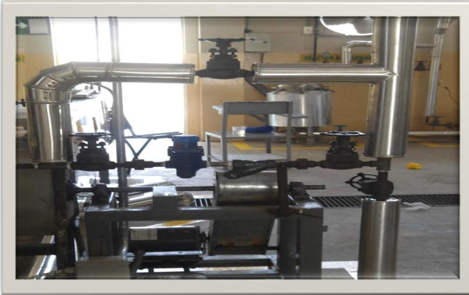
El Secador de Túnel cuenta con un sistema de vapor para su operación.
