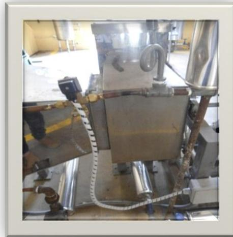
La resistencia eléctrica es un sistema de apoyo para el proceso de secado cuando la temperatura no es la apropiada para que se desarrolle el secado.
