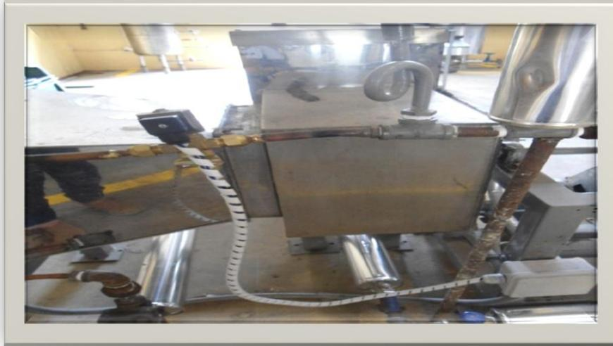
La electroválvula es un sensor eléctrico el cual dependiendo de las necesidades de temperatura del equipo, permite o no el paso de vapor a la cámara de aire caliente.
