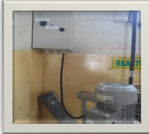
El panel de control consta de dos botones: el de encendido y el botón que regula las revoluciones del agitador.
