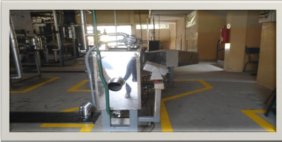
La salida del flujo de aire que atraviesa la cámara de secado se encuentra en la parte lateral izquierda del secador, posee un radio de 11cm.
