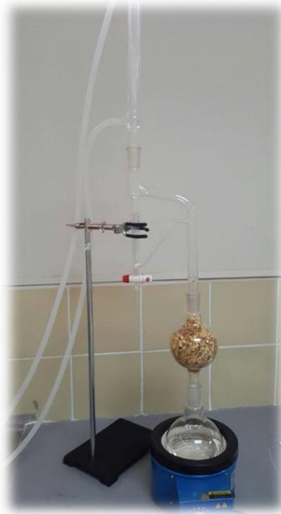
Armado y puesta en funcionamiento el equipo de extracción por arrastre de vapor
