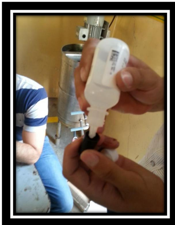
*Cloruro de potasio para calibración de equipo*
