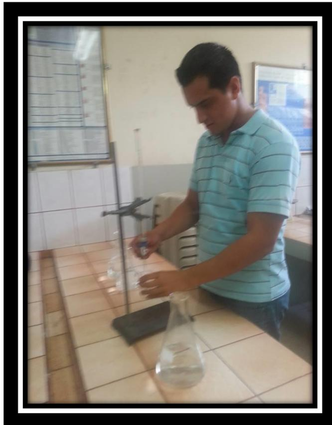
*Determinación de dureza.*
