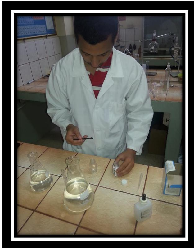
*Análisis de determinación de dureza.*
