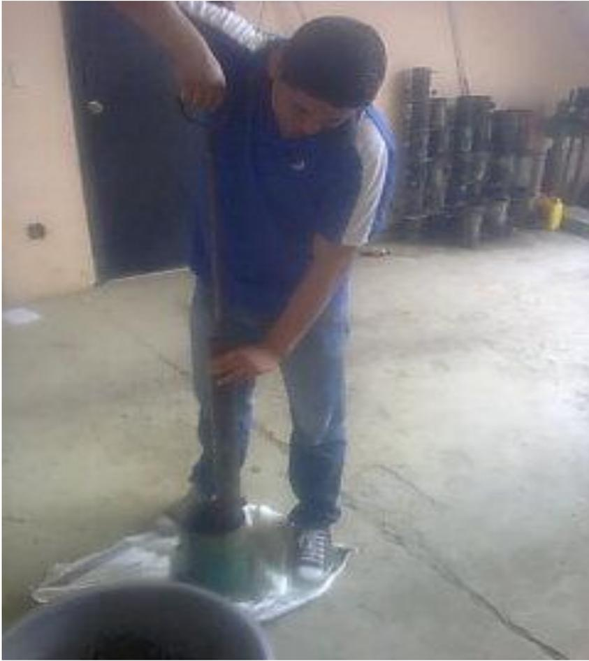
**Fotografía 2-10 Compactación en Molde Metálico**
