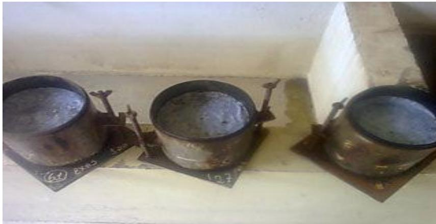
**Fotografía 2-11 Muestra compactada en Ensayo CBR**
