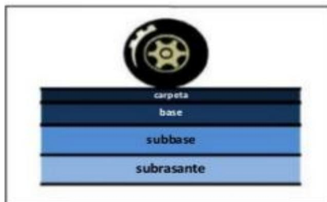
**Figura 1-1 Esquema La estructura del pavimento**
