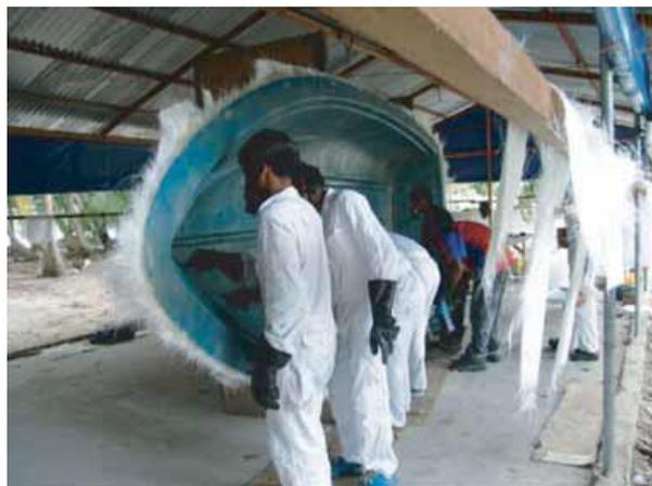
**Figura 7.** Colocación del mat de fibra de vidrio
