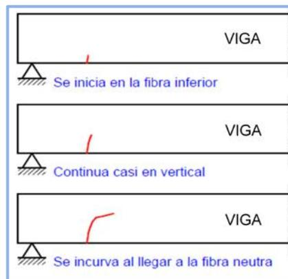
Ilustración 9.-Evolución de las fisuras por flexión
