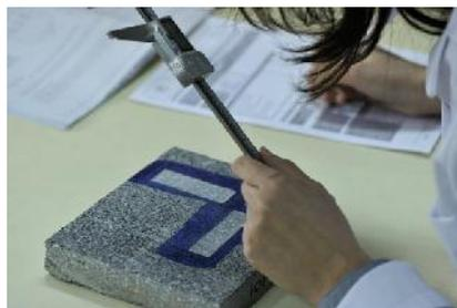
*Ilustración 17 Resistencia al desgaste*
