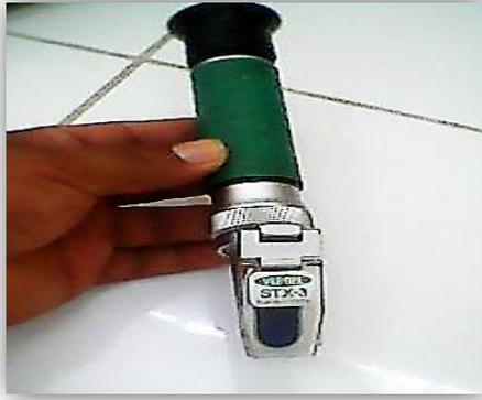
**Ilust.21: Tipo de salinómetro utilizado**
