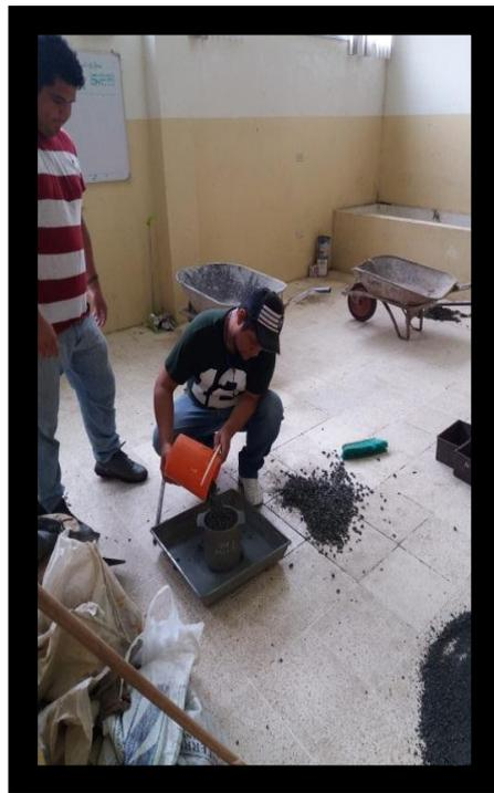
**Anexo 4.** Ensayos de peso unitario para los agregados de la cantera Megarok
