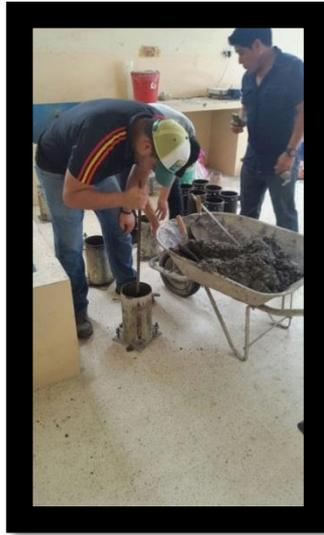
**Anexo 12.** Mezcla a punto para el proceso de llenado de los cilindros
