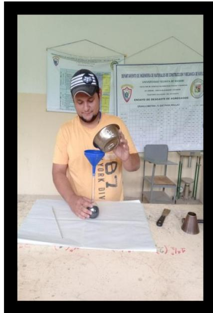
**Anexo 2.** Determinación de peso específico de los agregados
