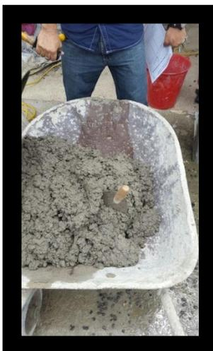
**Anexo 11.** Mezcla más Fibras de polipropileno y microfilamento fino
