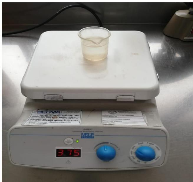
A. Plancha o Agitador térmico
