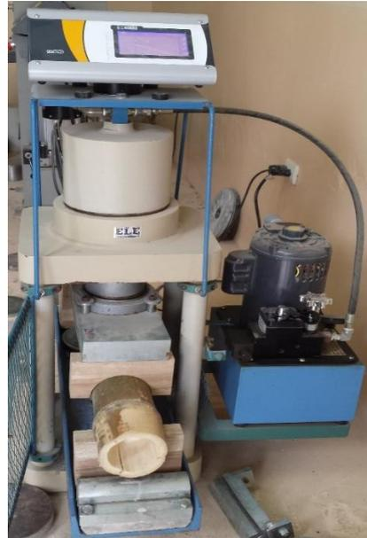
Fig. # 16 Máquina de flexión
