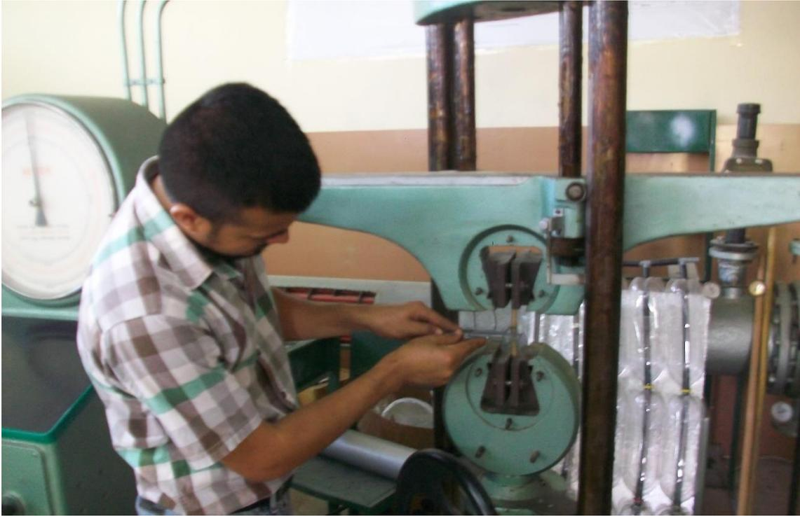
**Medida de la estricción de la probeta**
