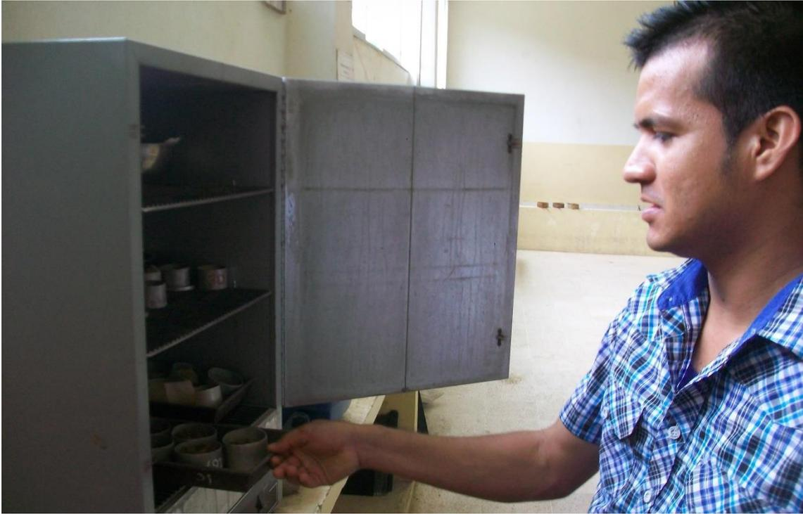
**Colocación de muestra de humedad natural en el horno**
