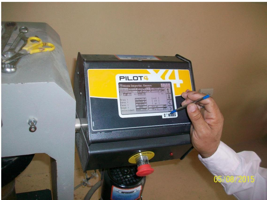
**Ingreso de datos al sistema para ensayo de compresión**
