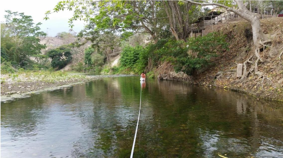
Figura 7. Parte del proceso de la medición del caudal en el sitio Hacienda El Rosario..
