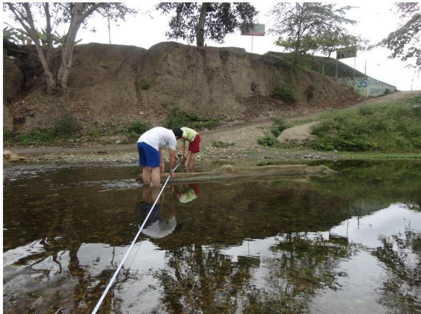
Figura 2. Parte del proceso de la medición del caudal en el sitio Atahualpa.
