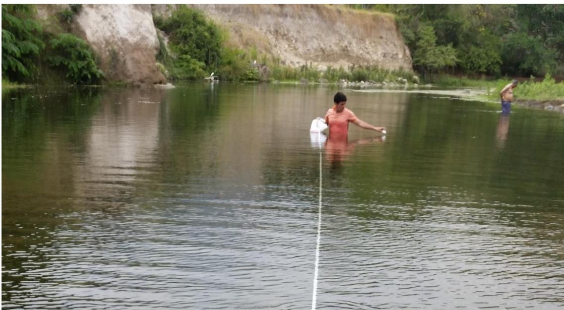
Figura 8. Parte del proceso de la medición del caudal en el sitio Quiauke.
