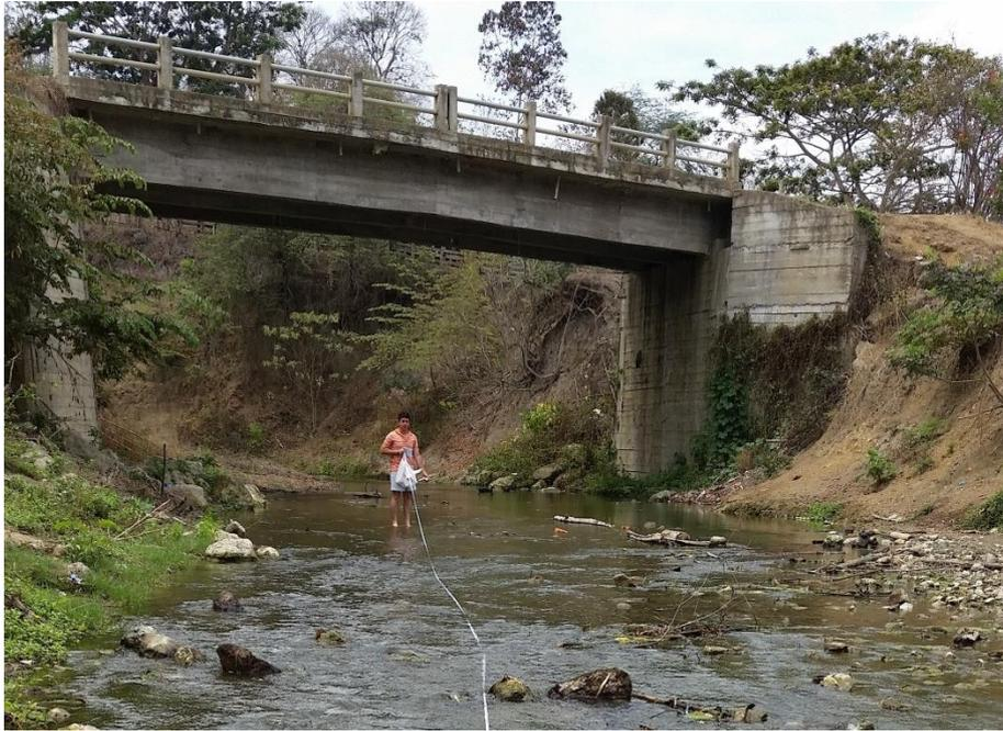
Figura 9. Parte del proceso de la medición del caudal en el sitio Santa Rosa.
