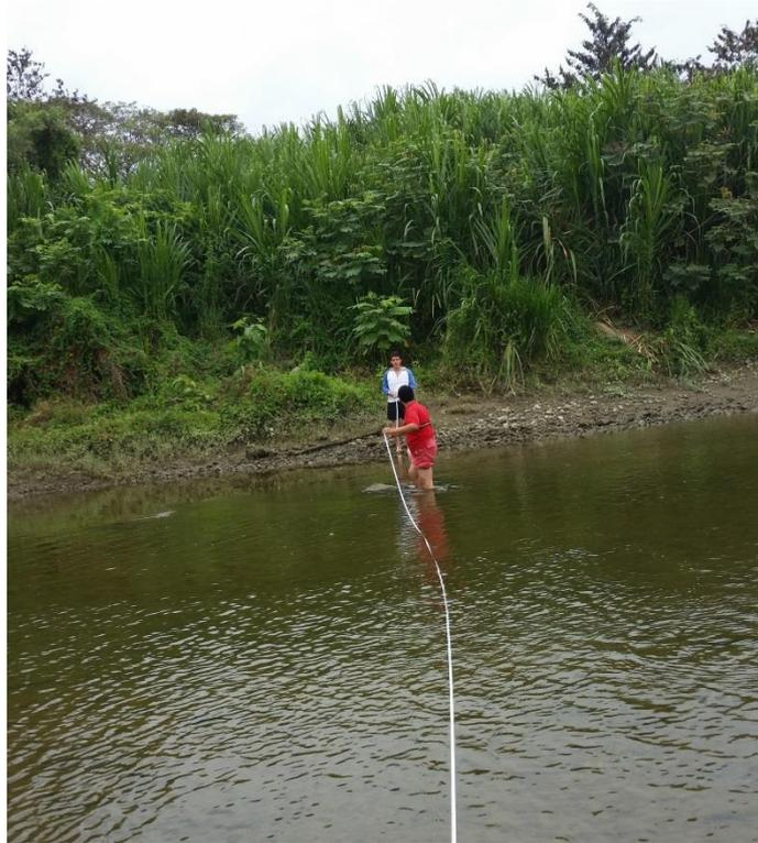
Figura 1. Parte del proceso de la medición del caudal en el sitio 5 de Agosto.
