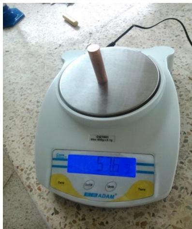
*Figura 33. Obtención de la masa del cilindro de cobre mediante la balanza*
