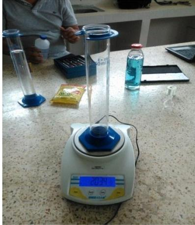
*Figura 34. Obteniendo masa de la Probeta*
