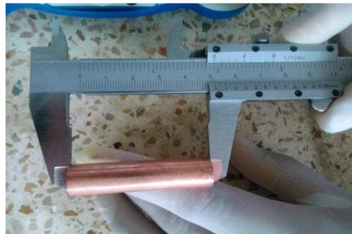
*Figura 32. Medición de la altura del cilindro de cobre*
