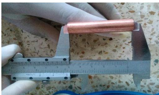
*Figura 15 Calibrador Vernier en Acero Inoxidable 0 - 150 mm*
