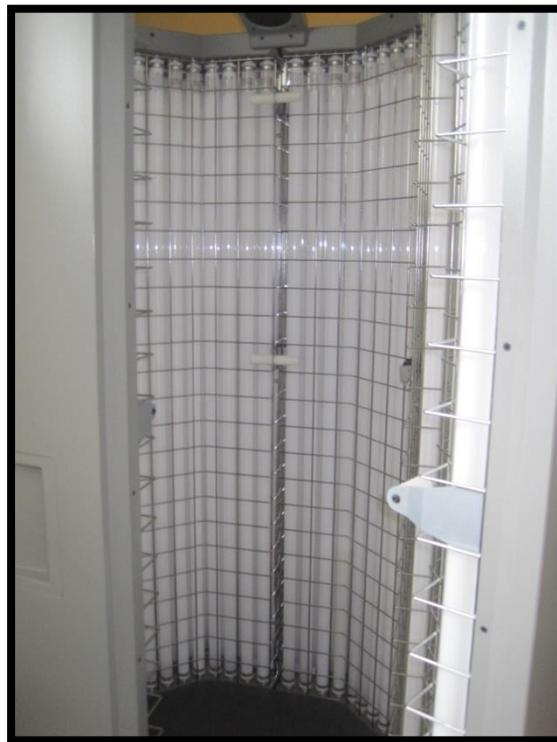
FOTO#4: equipo abierto donde se observan las lámparas de luz UV
