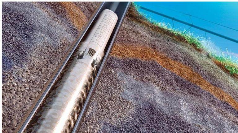
Una bomba sumergible es una bomba que tiene un impulsor sellado a la carcasa. El conjunto se sumerge en el líquido a bombear. La ventaja de este tipo de bomba es que puede proporcionar una fuerza de elevación significativa pues no depende de la presión de aire externa para hacer ascender el líquido.
