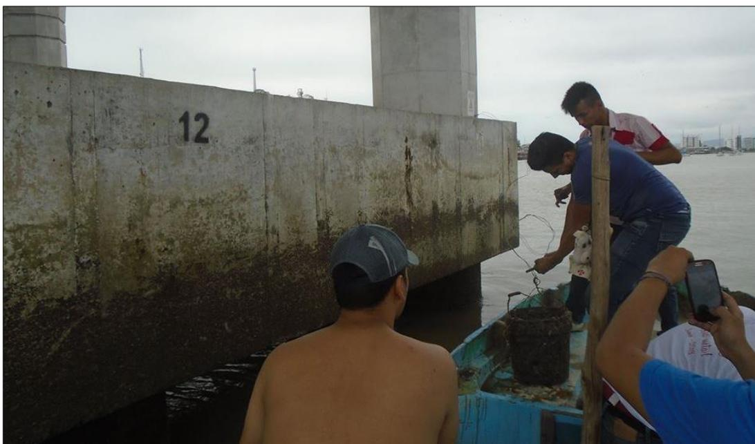
**Fotografía #38 – Extracción de los testigos curados en agua de mar de la Pila #12 para así realizar el ensayo de compresión en el laboratorio de suelos de la Universidad Técnica de Manabí.**
