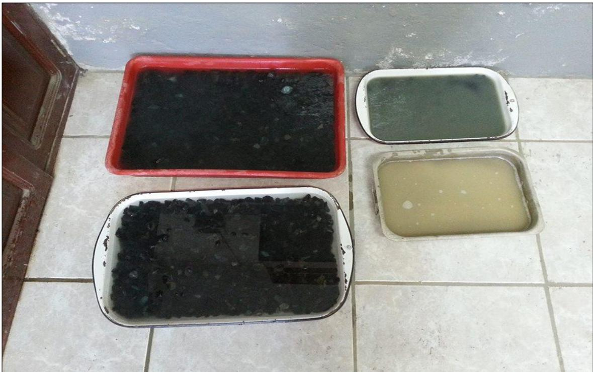
**Fotografía #6 – Saturación de los agregados durante 24 horas**
