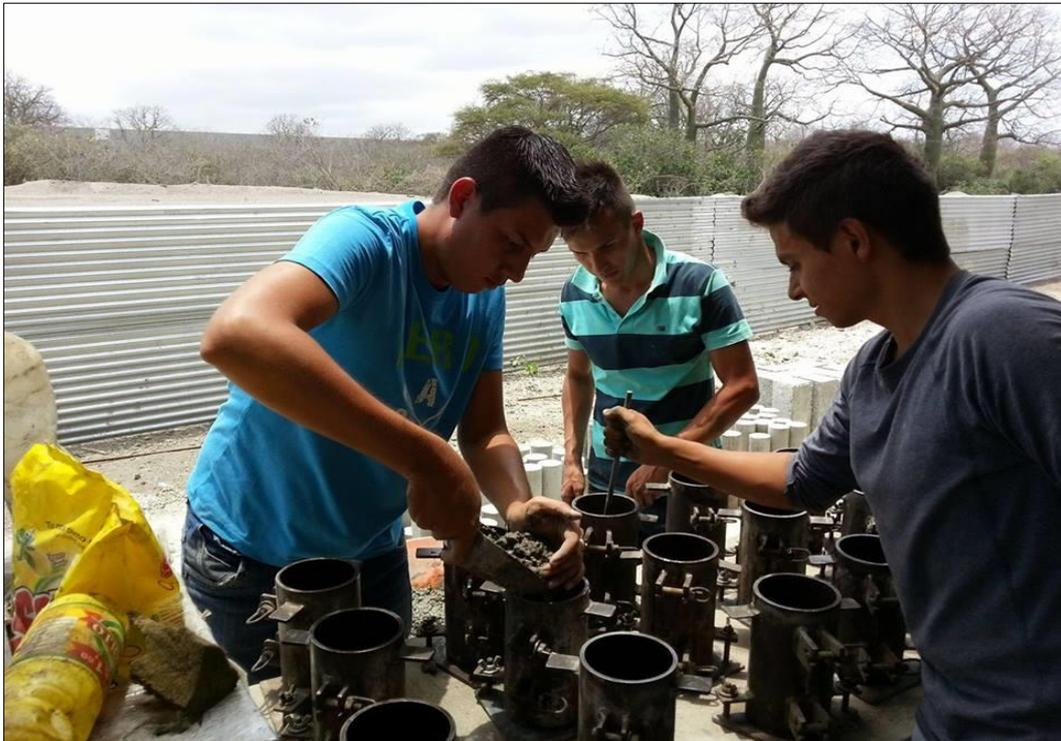
**Fotografía #20 – Elaboración de los cilindros de hormigón en las instalaciones de la constructora de Ciudad Rodrigo**
