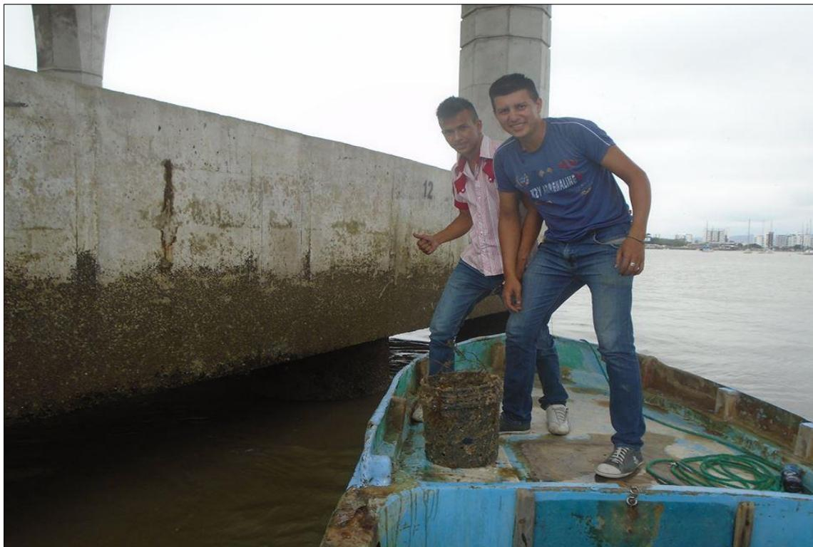
Fotografía #39 – Cilindros de hormigón extraídos para su ensayo de compresión.
