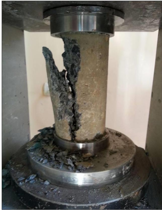
**Fotografía #45 - Verificación de la ruptura del testigo, curado a los 38 días en agua potable.**
