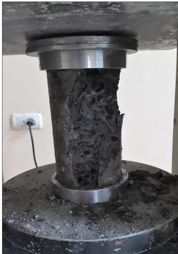
Fotografía #42 - Verificación de la ruptura del testigo, curado a los 29 días en agua de mar.
