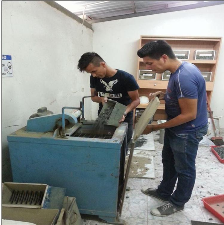
**Fotografía #13 – Granulometría del agregado grueso**
