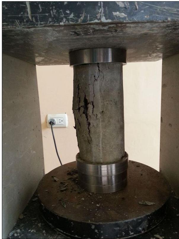
Fotografía #33 – Verificación de la ruptura del testigo, curado a los 7 días en agua potable.
