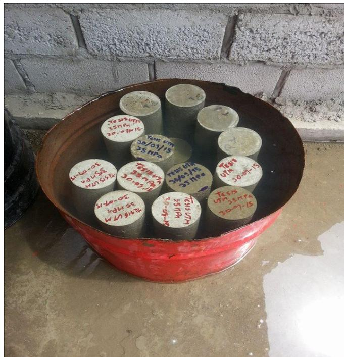
**Fotografía #26 – Testigos curados en agua potable**
