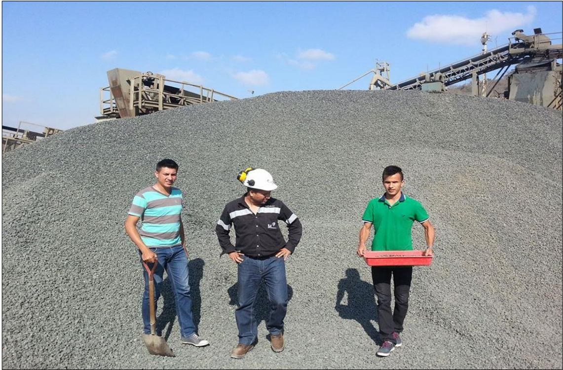
**Fotografía #3 – Recolección de muestra del agregado de ½ pulg. (Piedra #6)**
