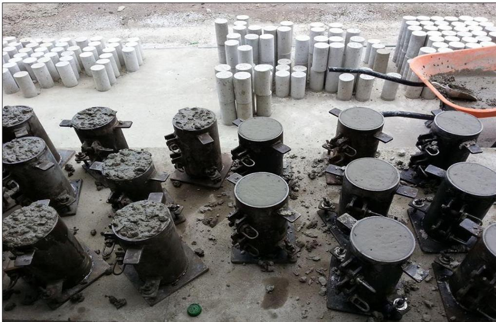
**Fotografía #22 – Enrazamiento de los cilindros de hormigón**
