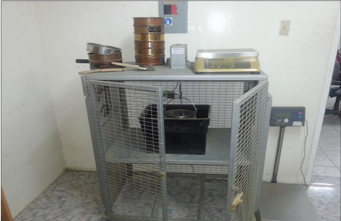
**Fotografía #7 – Equipo de laboratorio para realizar el ensayo de Gravedad Específica a los agregados gruesos.**
