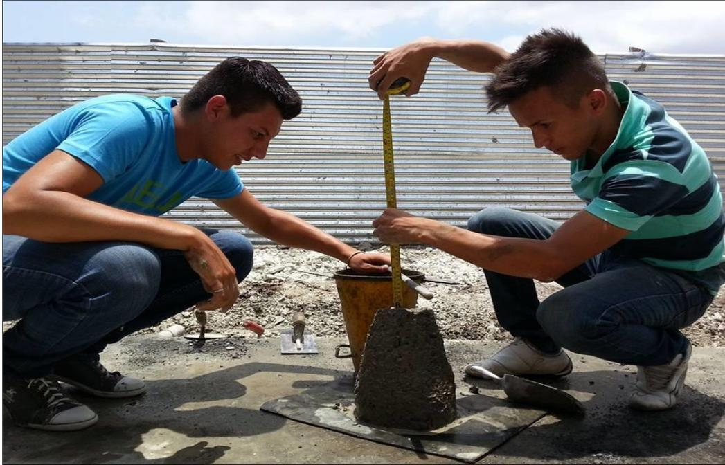
**Fotografía #19 – Asentamiento mediante el ensayo del cono de Abrams.**
