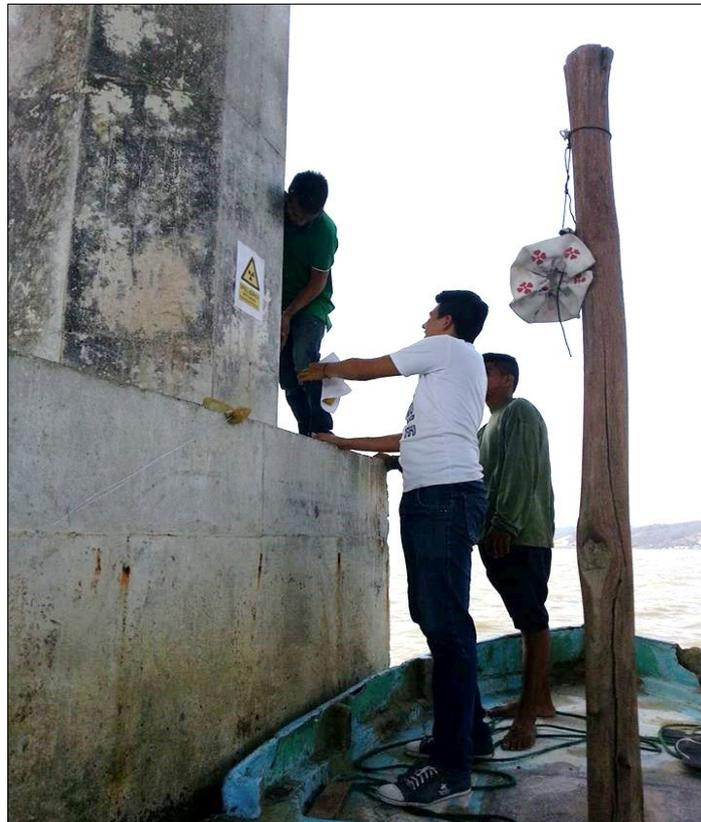
**Fotografía #30 - Muestra sumergida en la Pila #36 del puente Los Caras en Bahía de Caráquez.**
