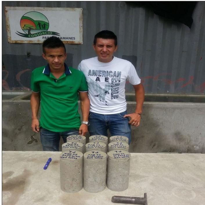
**Fotografía #25 – Cilindros de hormigón que serán curados en agua de mar junto a las vigas de enlace del puente Los Caras ubicado en Bahía de Caráquez**
