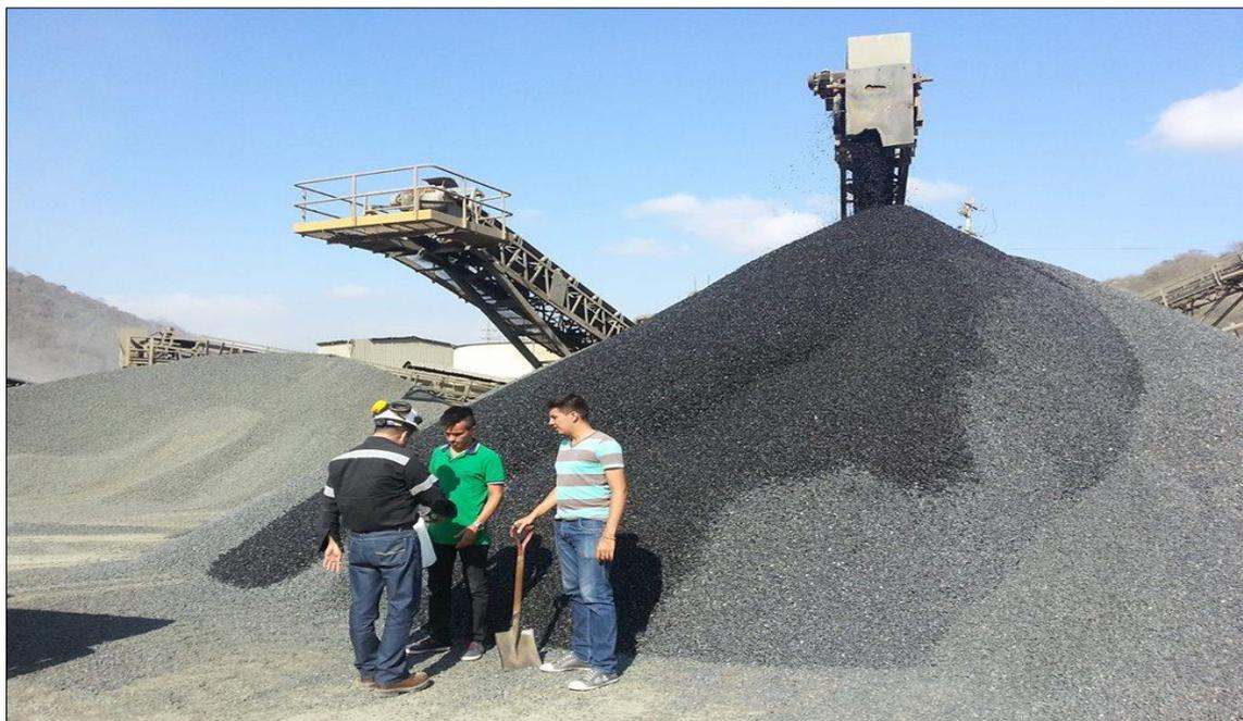
**Fotografía #2 – Recolección de muestra del agregado de ¾ pulg. (Piedra #7)**
