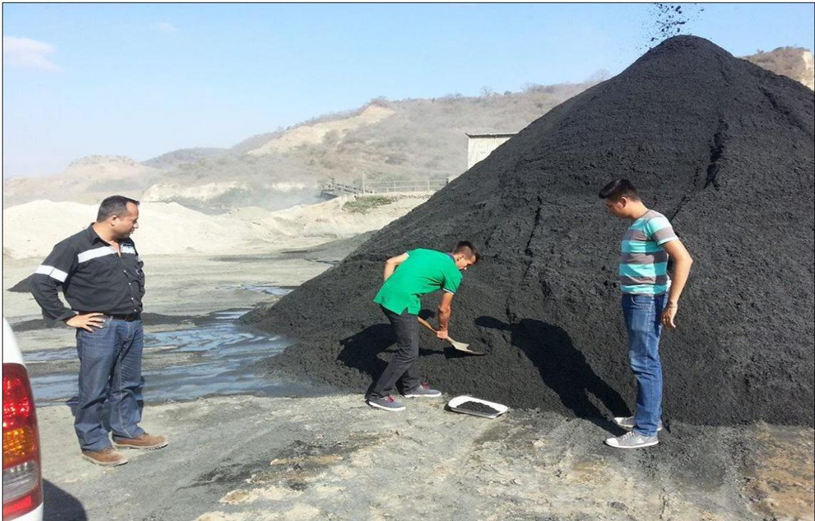
**Fotografía #4 – Recolección de muestra de la arena homogenizada para sus ensayos de laboratorio**
