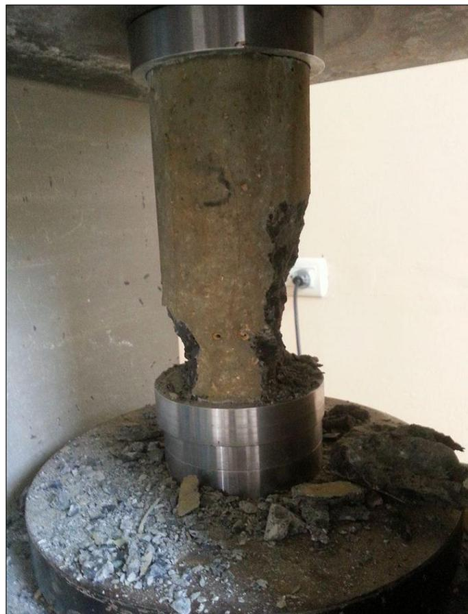
Fotografía #36 - Verificación de la ruptura del testigo, curado a los 29 días en agua potable.
