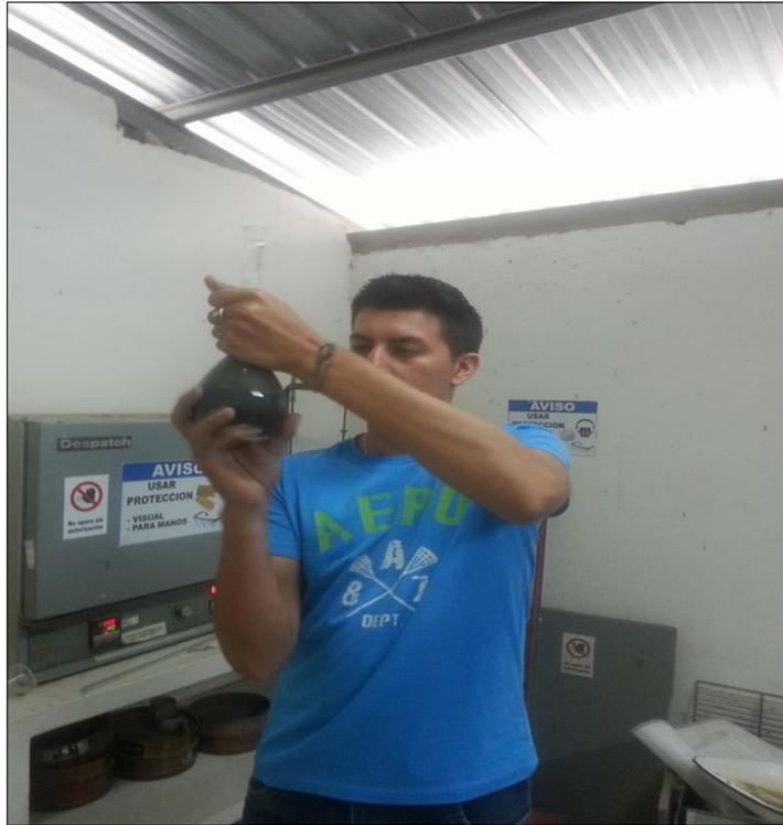
**Fotografía #9 – Ejecución del ensayo de gravedad específica a los agregados finos.**
