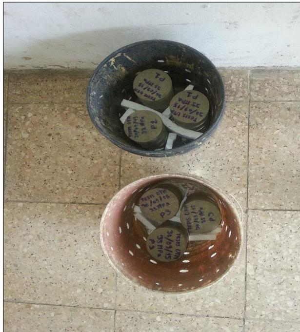
**Fotografía #27 – Recipientes con los cilindros de hormigón que serán curados en agua de mar.**
