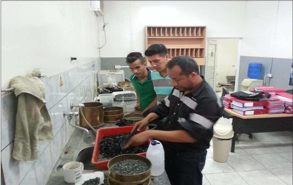
**Fotografía #5 – Lavado de los agregados para sus respectivos ensayos de laboratorio**
