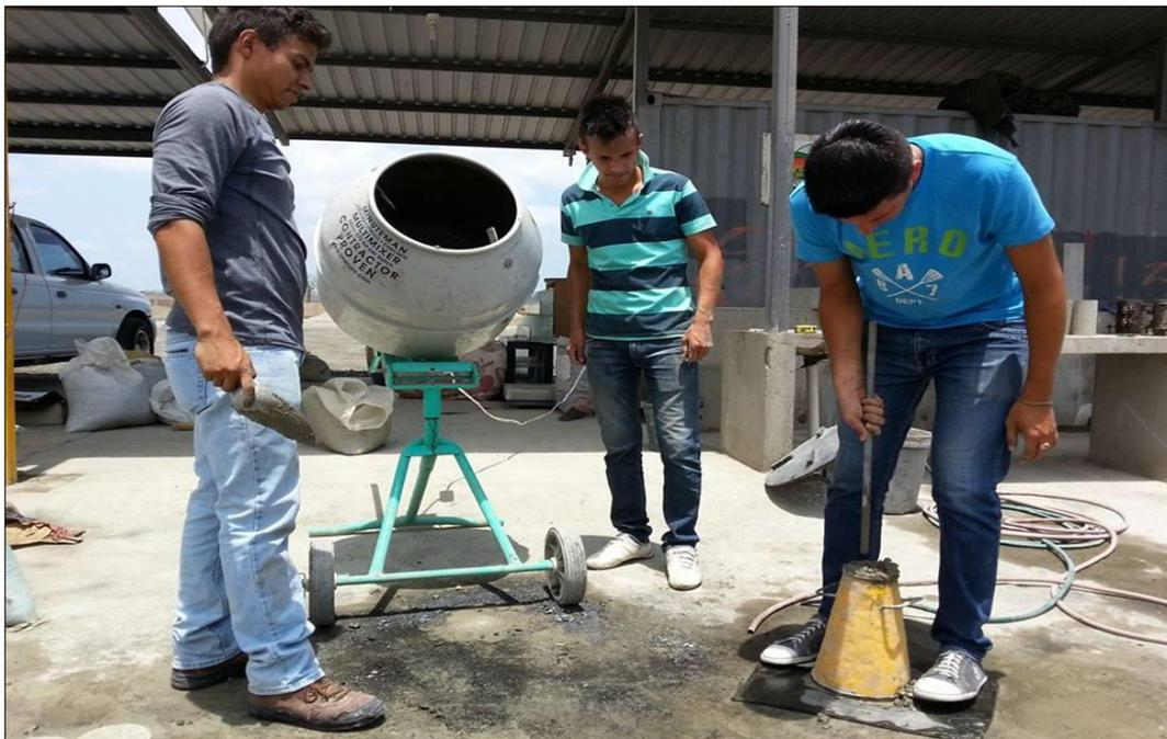
**Fotografía #18 – Comprobación de la mezcla de hormigón mediante el cono de Abrams.**
