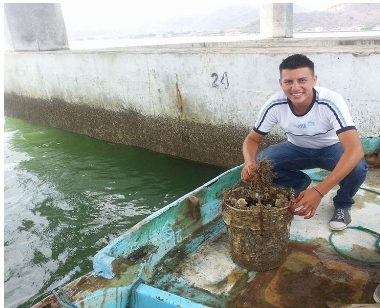
**Fotografía # 46 - Extracción de los testigos curados en agua de mar de la Pila #24 para así realizar el ensayo de compresión en el laboratorio de suelos de la Universidad Técnica de Manabí.**
