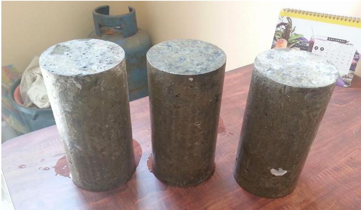
Fotografía # 47 – Testigos curados en agua de mar con un tiempo establecido de 38 días, para realizarle el ensayo de compresión
