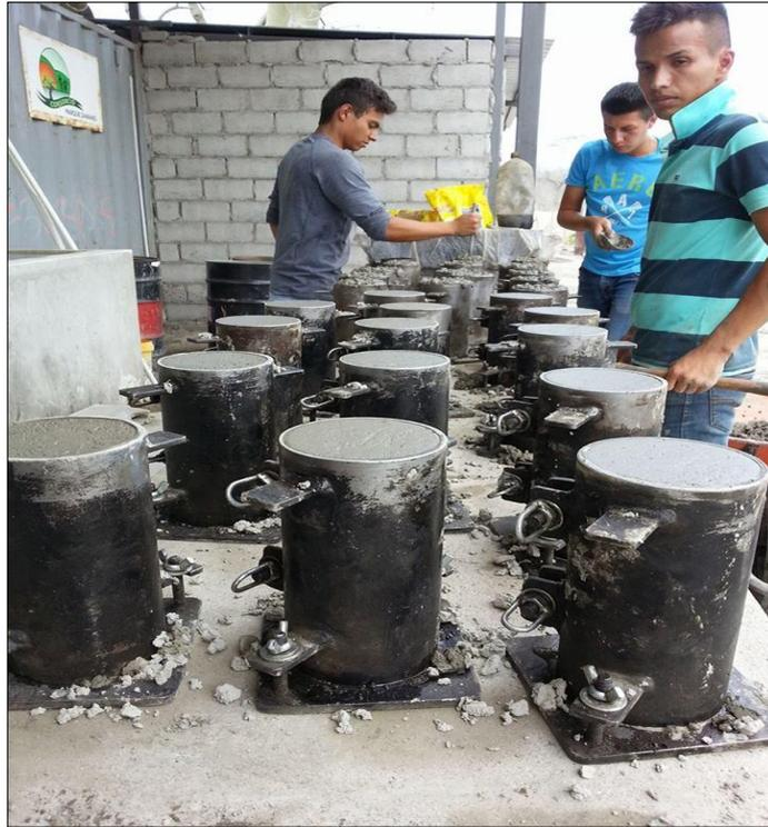
**Fotografía #21 – Parte de los Cilindros de hormigón ya terminados.**
