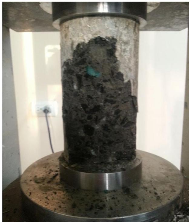
Fotografía # 50 - Verificación de la ruptura del testigo, curado a los 38 días en agua de mar.
