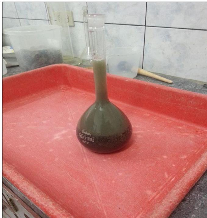
**Fotografía #10 – Eliminación del aire de la arena homogenizada en el matr az para su ensayo de gravedad espec fica.**
