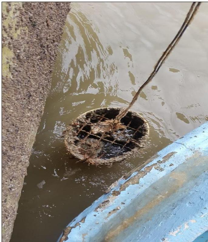
**Fotografía #37 – Extracción del recipiente con los cilindros de hormigón curados en agua de mar.**
