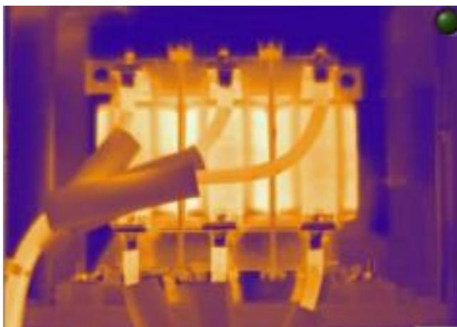
Figura 1. Ensayo termográfico a transformadores
