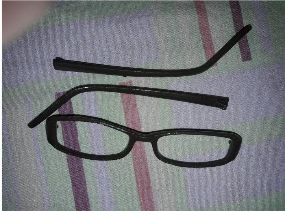
Prototipo de armazón de Plástico PET terminado
