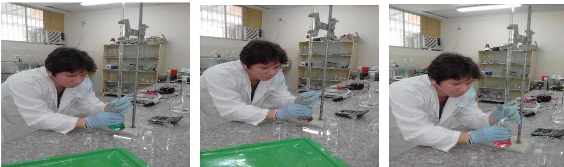
Proceso de destilación y recuperación de nitrógeno producto de la digestión de las muestras del King Grass Morado y la Caña de Azúcar a base de ácido sulfúrico.
