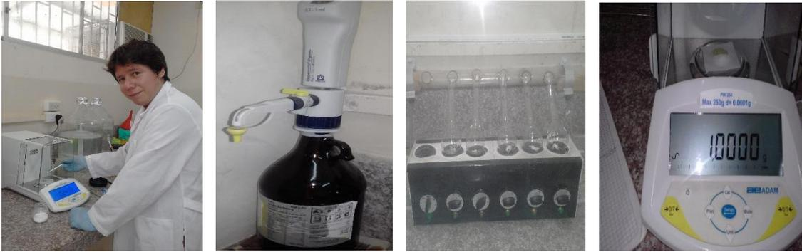
Pesaje de las muestras (0,25 g) y catalizador (1 g) para analizar el % de proteína, con la aplicación ácido sulfúrico (3 ml), para el proceso de digestión.
