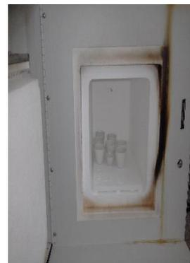
Evaluación de muestras mediante las pruebas de la ceniza se calculando el % ceniza en la estufa LIMDBERG/BLUE M.
