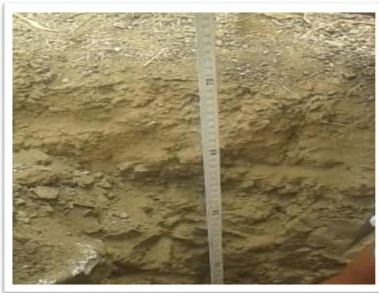
**ANEXO 10:** Excavación de la primera capa de estrato para muestreo de suelo
