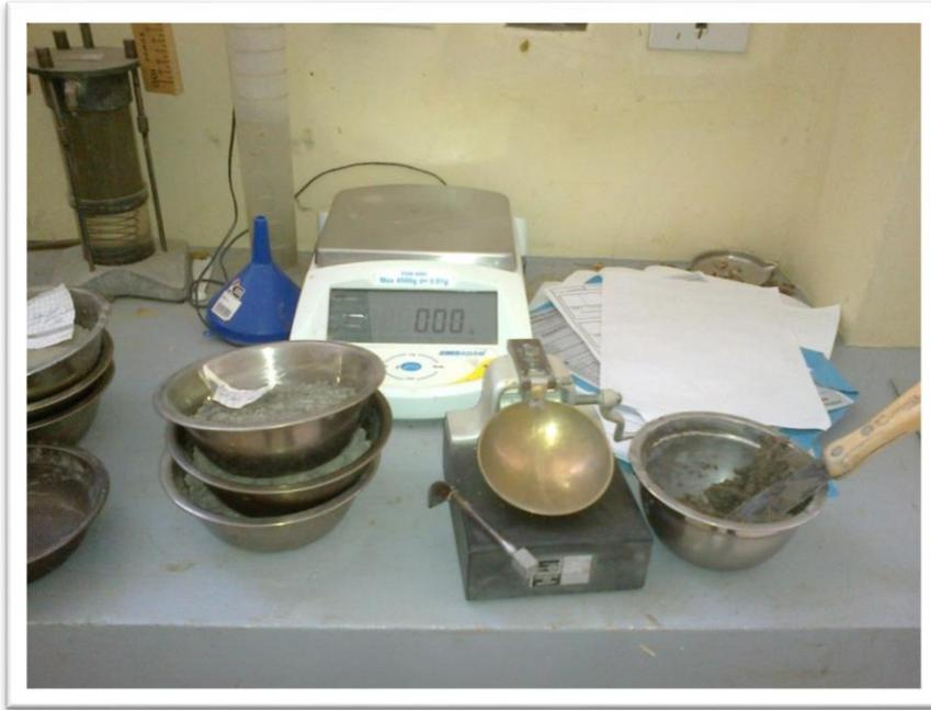
**ANEXO 13:** Equipo y materiales para ensayo de límites de consistencia
