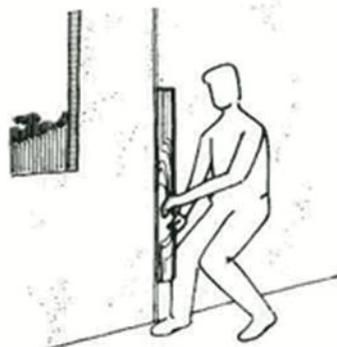
Imagen 53. Aplicación de segunda capa de mortero
