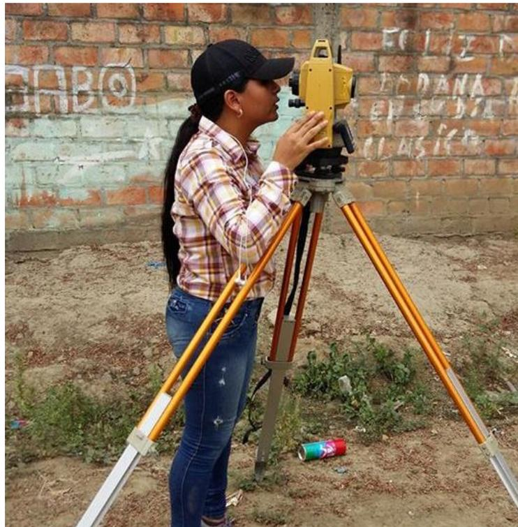
Trabajo de levantamiento topográfico para el diseño de la vía de acceso
