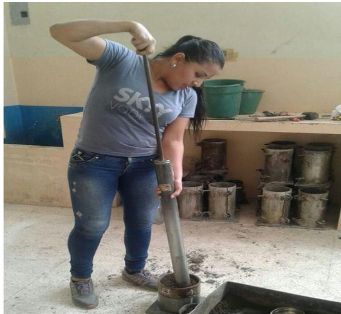
Ensayos de Proctor realizados en laboratorio
