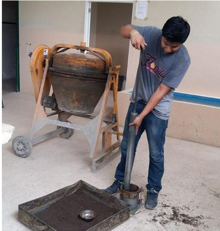
Realización de ensayos en laboratorio: Proctor
