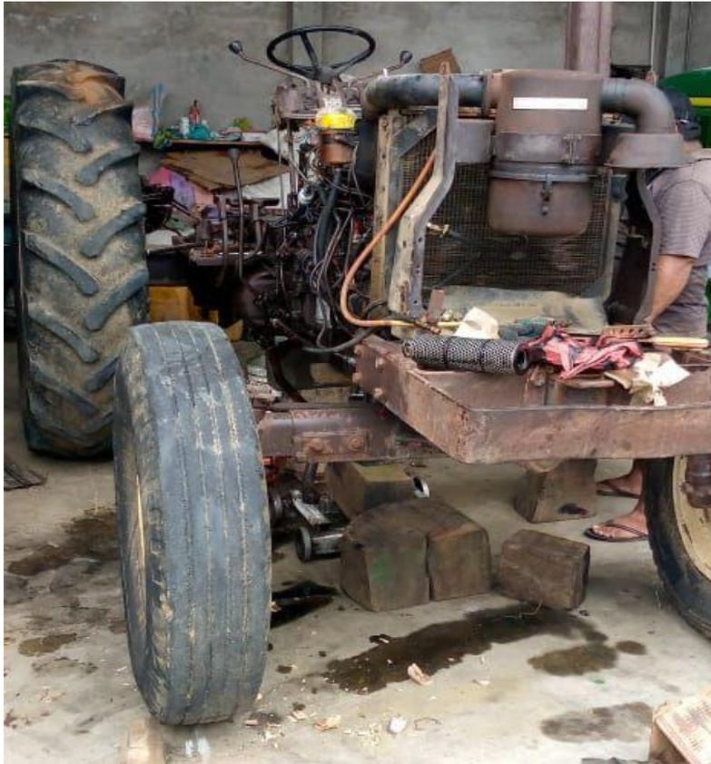
**FOTO:** Desarme de la carrocería completa e inspección del sistema hidráulico y eléctrico (parte interna).
