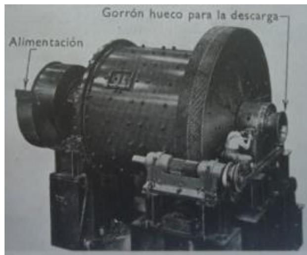
**Figura 1.** Molino de bolas con tolva de alimentación y gorrón hueco para la descarga (Allis-Chalmers Mfg. Co.)
