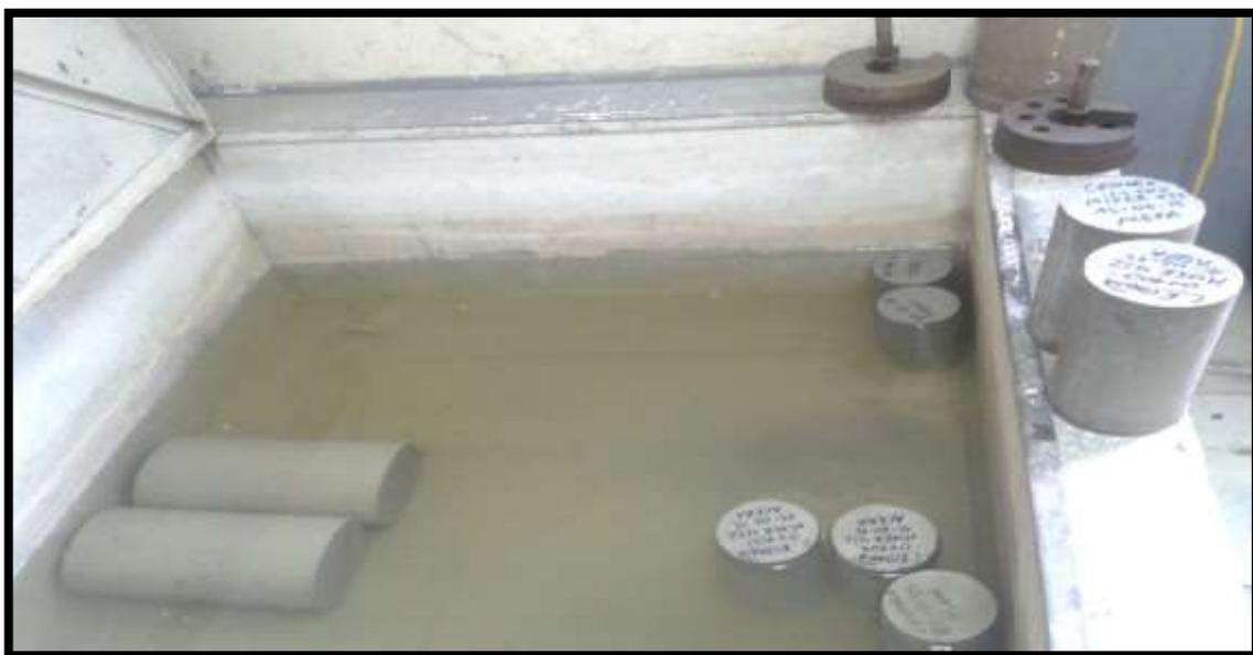
**FOTO#44: Cilindros de hormigón bajo el agua**
