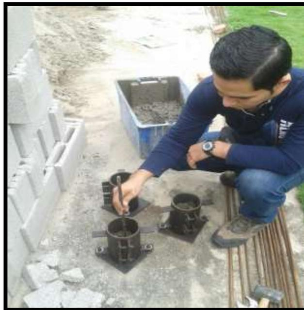
**FOTO#42: Preparación de cilindros de hormigón**
