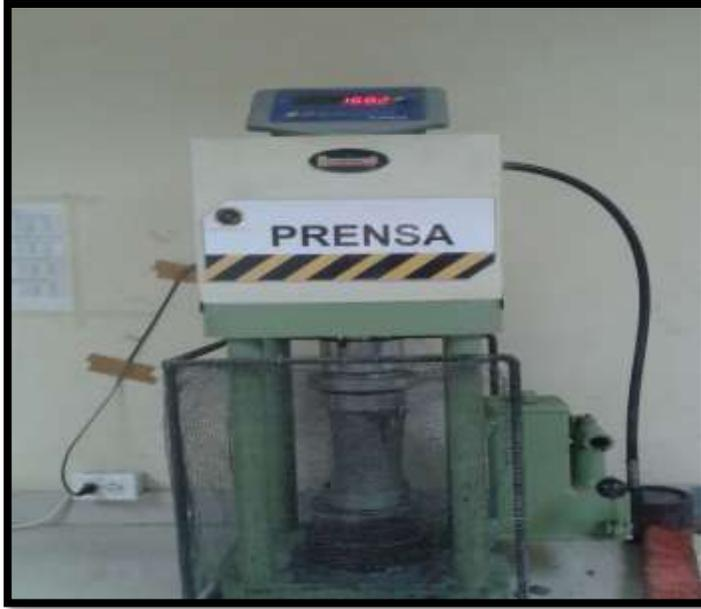
**FOTO#49: Ruptura de cilindro de hormigón**
