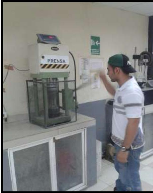
**FOTO#45: Ruptura de cilindros de hormigón**
