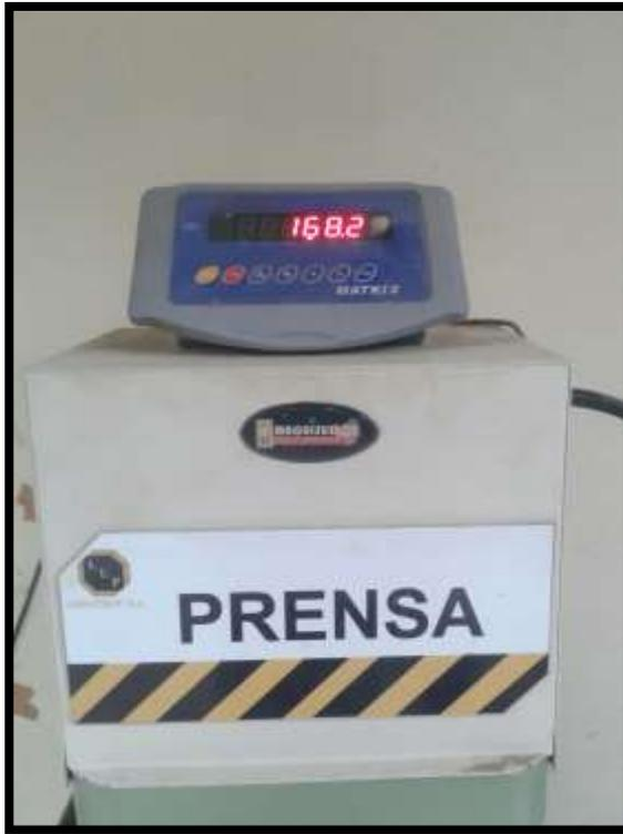
**FOTO#47: Resultados de 21 días del cilindro de hormigón**
