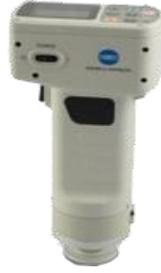
**Figura 3.** Colorímetro Konica Minolta CR-400
