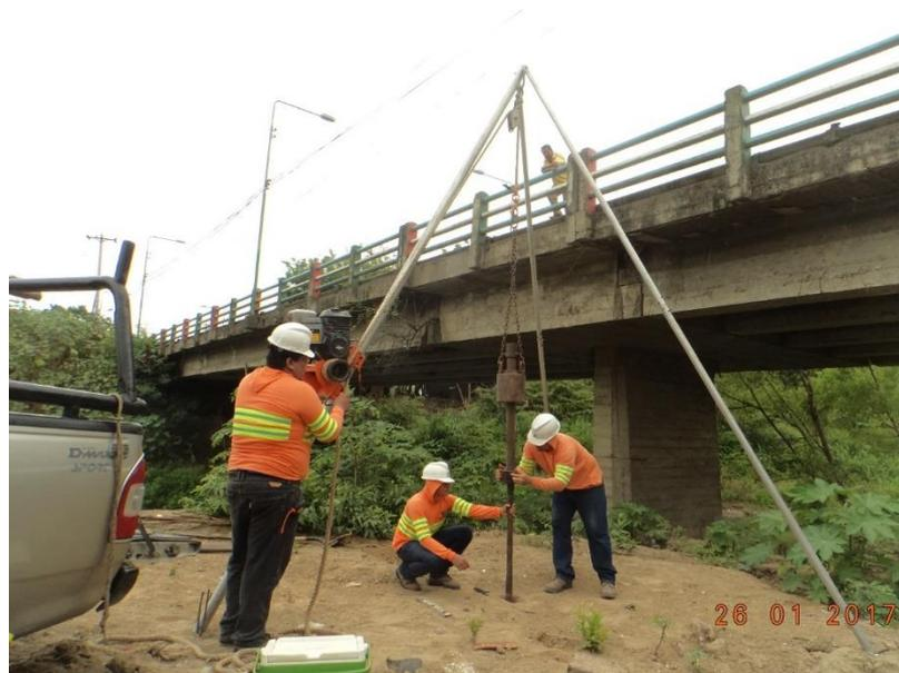
figura 9. Penetrómetro
