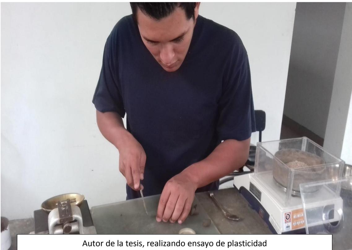
Autor de la tesis, realizando ensayo de plasticidad
