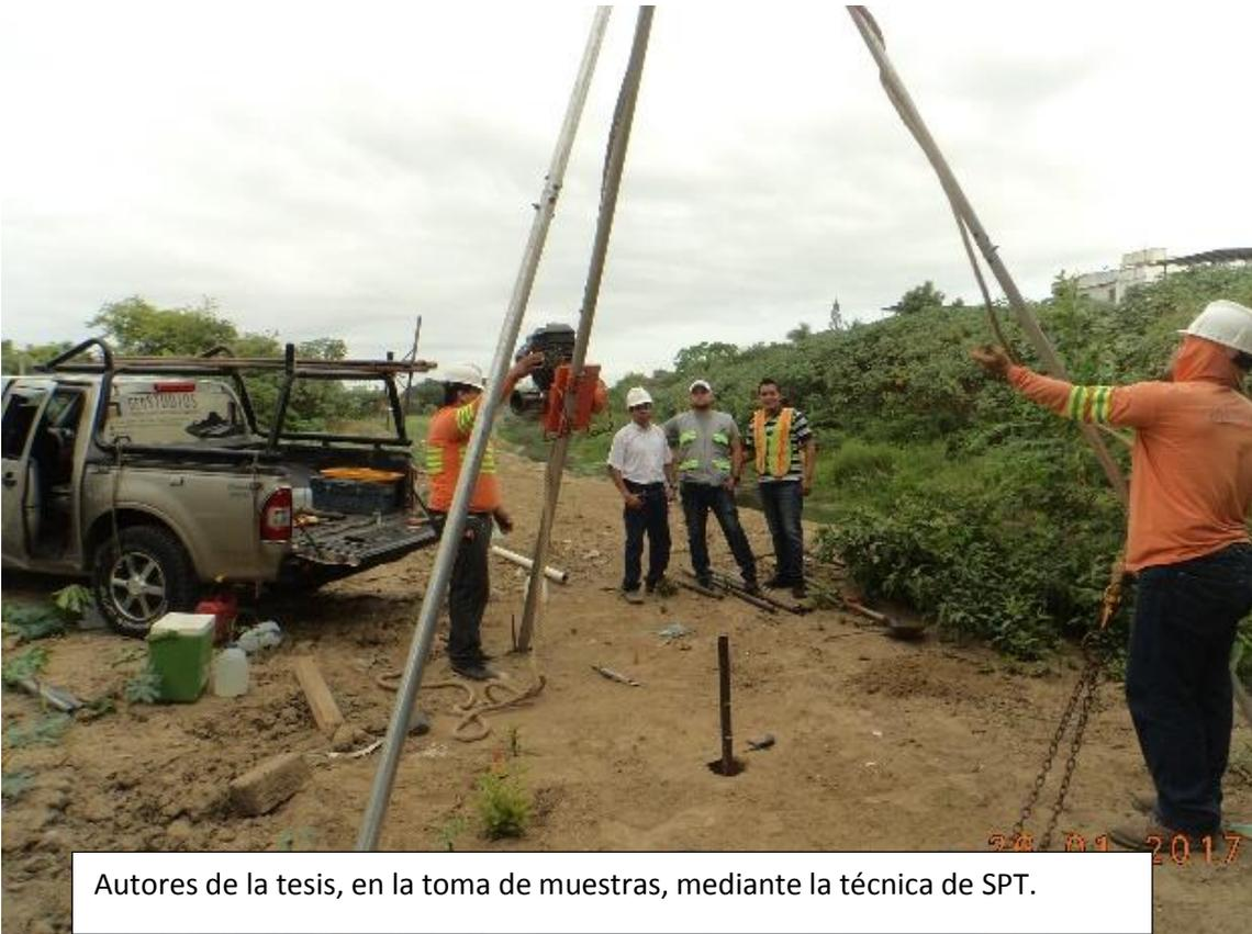
Autores de la tesis, en la toma de muestras, mediante la técnica de SPT.
