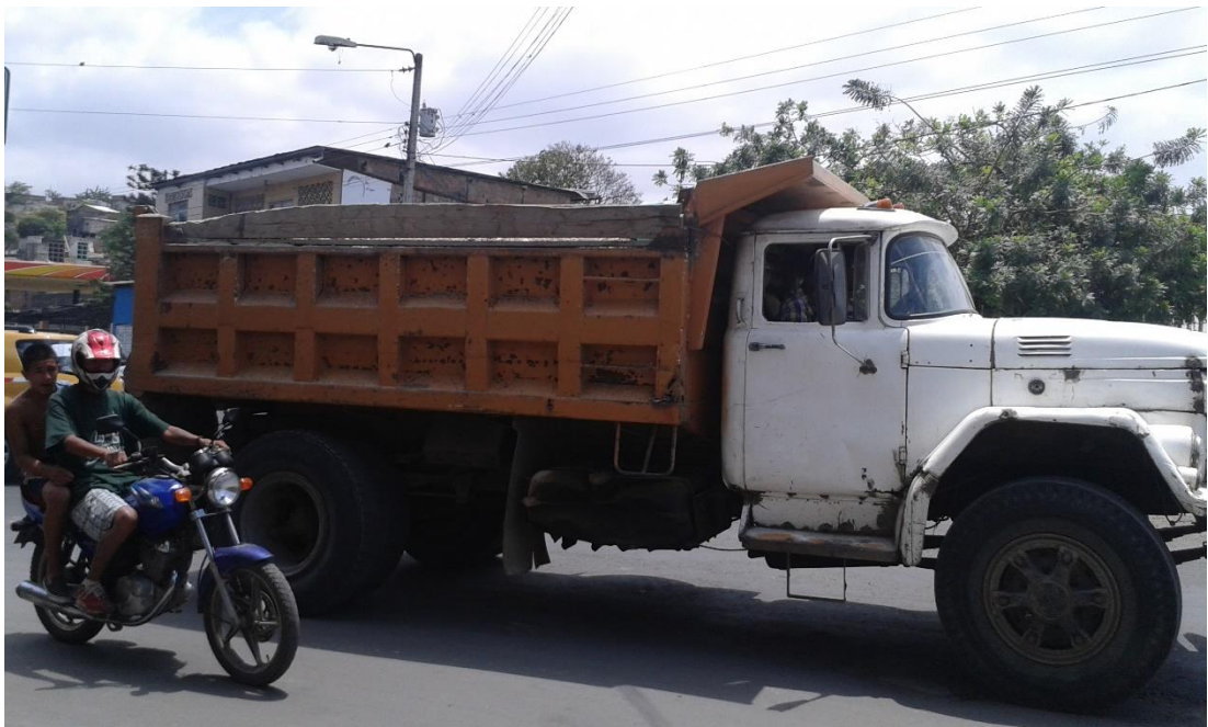
Figura 18: Volqueta con tablón en la parte del balde, con la finalidad de generar mayor volumen de transporte de carga que le permitido
