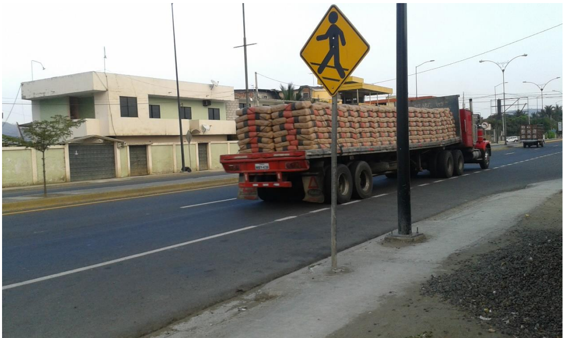
Figura 20: Transporte de carga pesada con 5 ejes (1 simple – 4 dobles)
