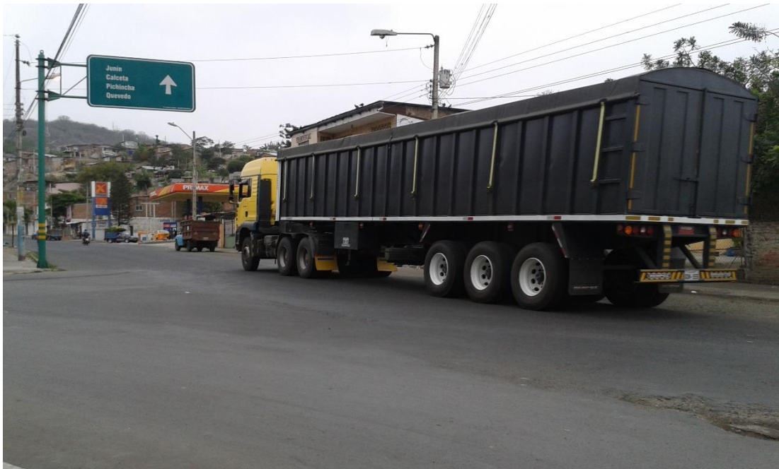
Figura 21: Transporte de carga pesada con 6 ejes (1 simple – 5 dobles)
