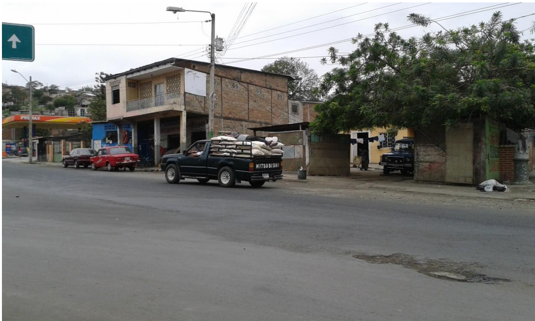
Figura 22: Vehículo liviano con exceso de carga, notorio asentamiento en eje trasero
