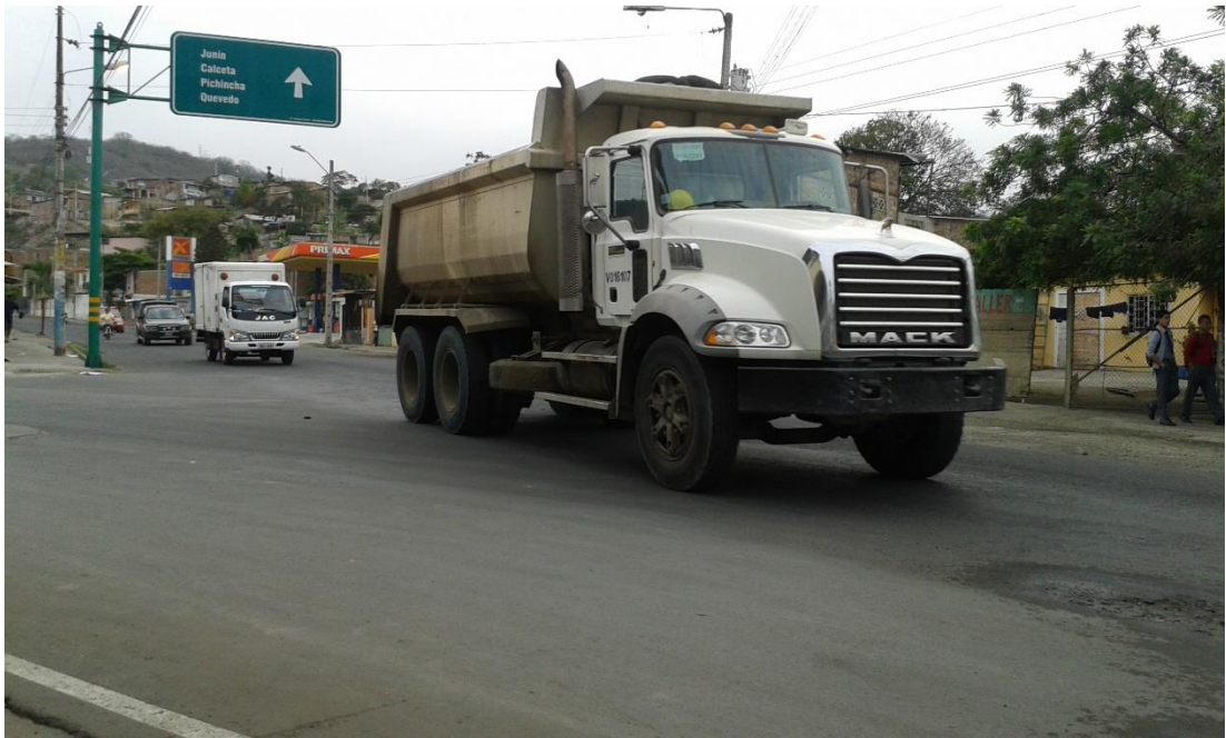
Figura 19: Volquetas con tres ejes (1 simple – 2 dobles)
