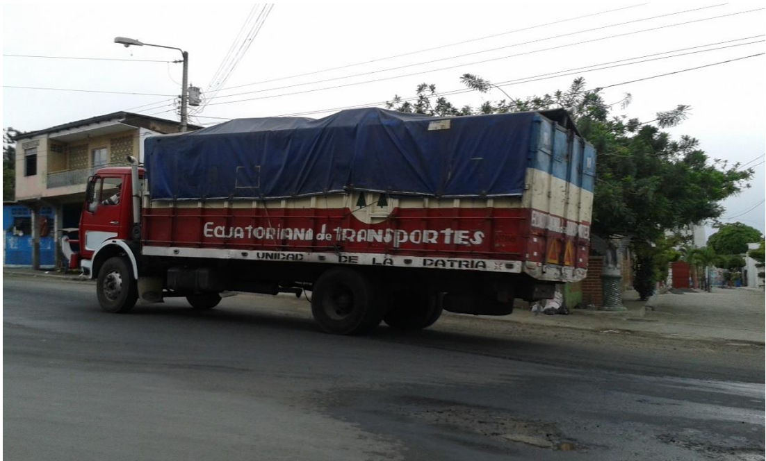
Figura 17: Camiones de carga pesada (1 eje simple – 1 eje doble)
